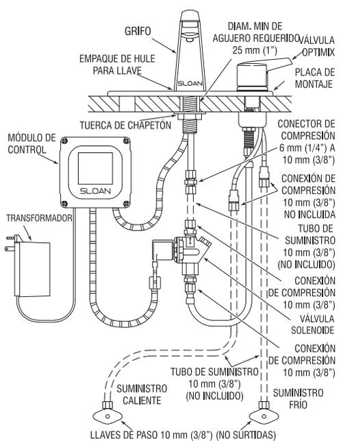
**Llave ETF-880 c/Válvulas Mezcladoras Variaciones BDM y BDT para Suministro de Agua Caliente y Fría (se muestra c/placa de montaje de 4")**
