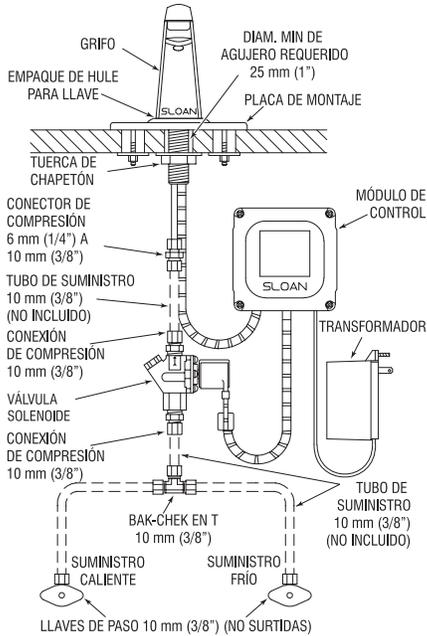
**Llave ETF-80 con Válvula Mezcladora Variación ADM para Suministro de Agua Caliente y Fría (se muestra con placa de montaje de 8")**
