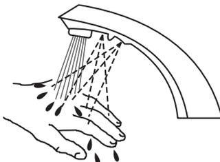
3. Al retirar las manos del Sensor OPTIMA®, la pérdida de luz reflejada inicia una señal eléctrica que desactiva la Válvula Solenoide, cortando el flujo de agua. El Circuito entonces se restablece automáticamente y está listo para el siguiente usuario.
