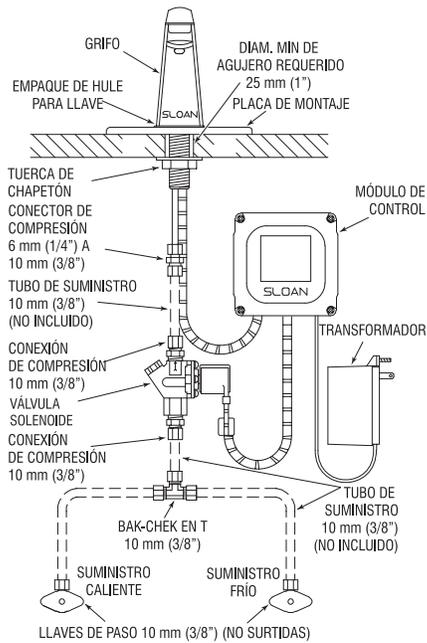
**Llave ETF-880 con Válvula Mezcladora Variación ADM para Suministro de Agua Caliente y Fría (se muestra con placa de montaje de 8")**
