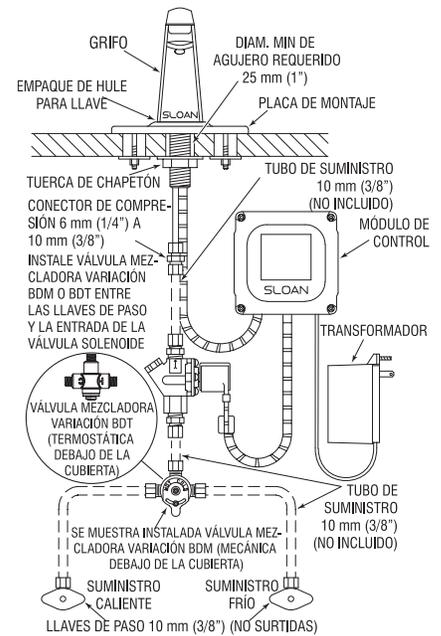
**Llave ETF-880 con Bak-Chek® en T para Suministro de Agua Caliente y Fría (se muestra con placa de montaje de 4")**
