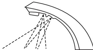
2. Al entrar las manos del usuario en el rango efectivo del haz (debajo del rociador), el haz se refleja en el receptor del sensor y activa la Válvula Solenoide permitiendo que fluya agua templada de la llave al lavabo. El agua fluye hasta que las manos se retiran o hasta que la Llave alcanza su valor prefijado automático de Pausa.
