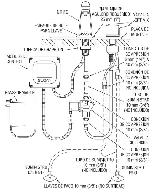
**Llave ETF-80 c/Válvulas Mezcladoras Variaciones BDM y BDT para Suministro de Agua Caliente y Fría (se muestra c/placa de montaje de 4")**
